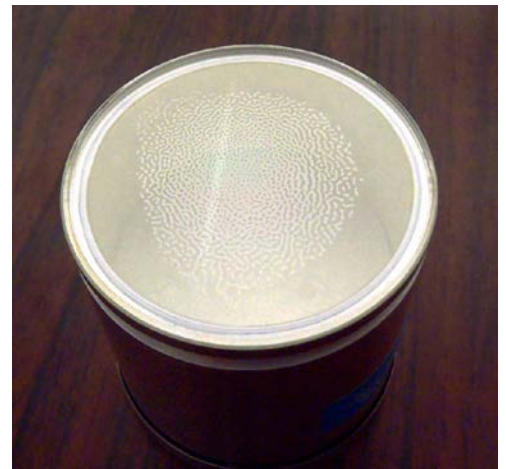
図-3 NaI シンチレータと光学窓のはがれ
